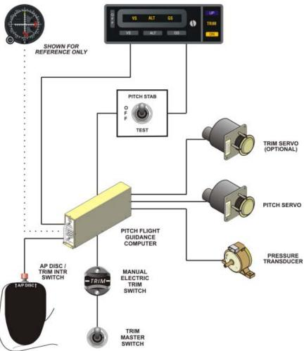
Fig. 1-1. System Sixty PSS Block Diagram
