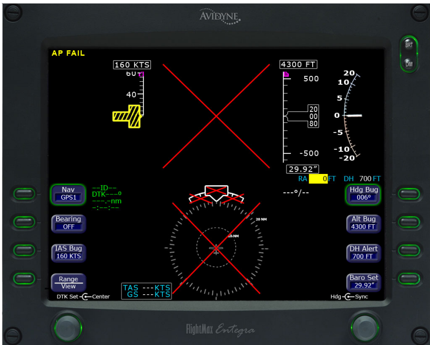
Fig. 2-9. PFD Display, ADAHRS Failure
