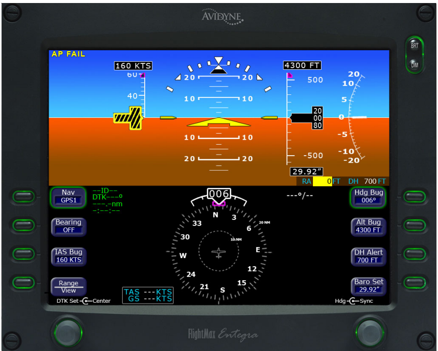
Fig. 2-7. PFD Display, AP FAIL
