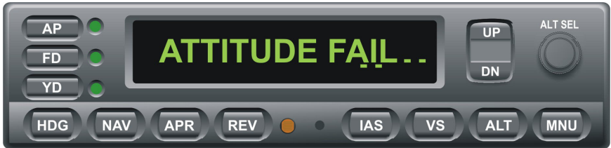
Fig. 2-8. AP Display, ADAHRS Failure
