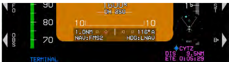
Figure T-15: Basic Mode Mini Traffic
